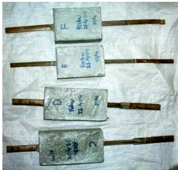
Gambar 11. Mesin Tarik dan Sampel Uji Lekatan Bambu-Mortar
