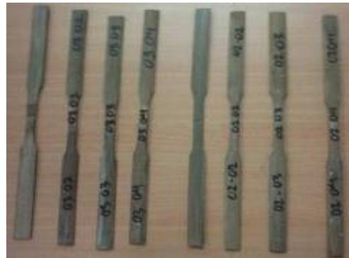
**Gambar 2. Sampel Bambu Tali untuk Uji Tarik Utuh (Bukan Sambungan)**
