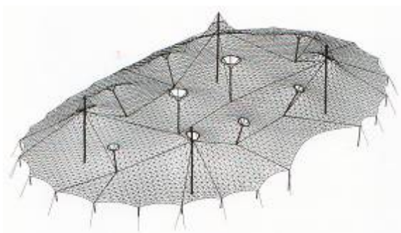
Gambar 6. Tampak Isometri dari Atap Stadion, Hasil Form Finding dengan Bantuan Komputer (Holgates, 1997)
