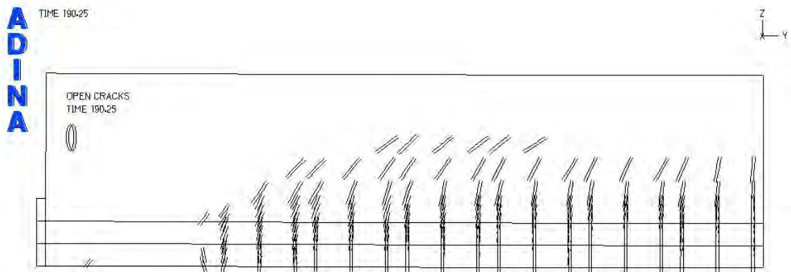
Gambar 15. Kondisi Runtuh Balok OA1
